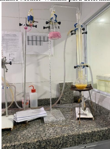
Figura 5. Análise Monier-William para determinação de SO 2
