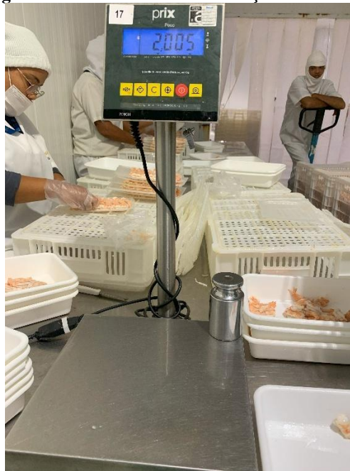
Figura 16. Procedimento de aferição de balanças
