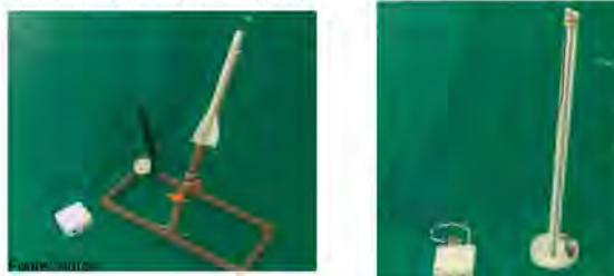
Figura 2. a) Sistema Experimental de queda livre microcontrolado; b) Sistema de medição de velocidade de lançamento de minifoguetes.
