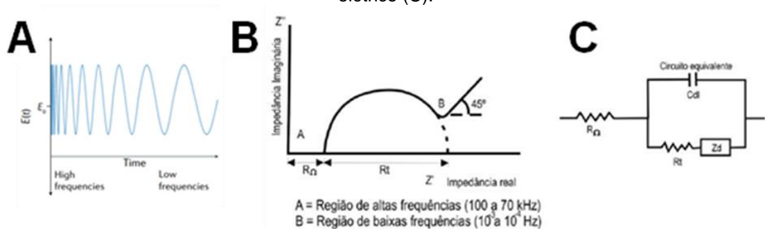
Figura 5 – Representações gráficas da perturbação do sistema (A), diagrama de Nyquist (B) e circuito elétrico (C).
