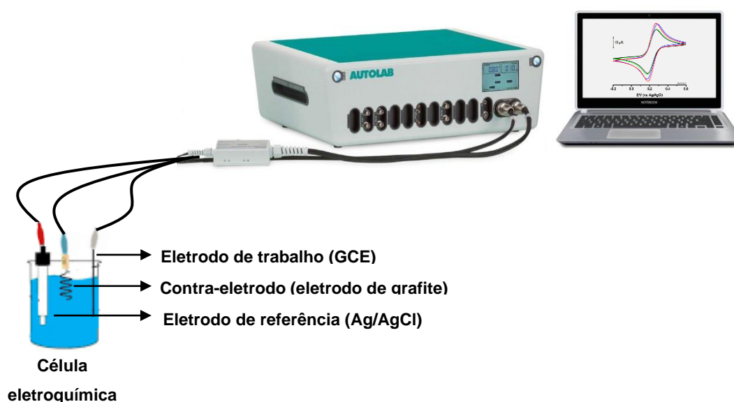
Figura 6 – Potenciostato e célula eletroquímica
