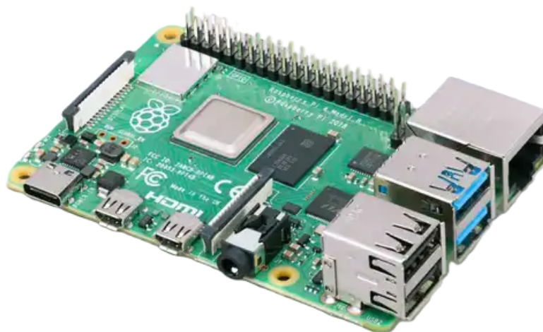
Figura 6. Exemplo de placa Raspberry Pi 4 Model B. Fonte: Site Raspberry Pi.
