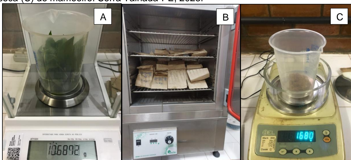
Figura 5. Aferição de massa fresca (A), secagem em estufa (B) e aferição de massa seca (C) de mamoeiro. Serra Talhada-PE, 2023.
