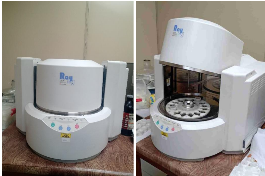
Figura 5 – Equipamento de EDX-720 (Shimadzu) - CRCN-NE.
