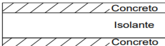
Figura 10 - Combinação do concreto/isolante no piso.
