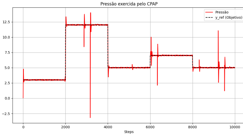
Figura 7: Gráfico da pressão em cmH 2 O. K_p = 10.0 , K_i = 1.2 , 48 neurônios por camada, ativação tanh, divisão dos inputs nas duas primeiras camadas. O resto dos parâmetros podem ser consultados na tabela 2.
