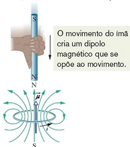
Figura 5: Aplicação da Lei de Lenz, mostrando um ímã se aproximando e gerando uma corrente
