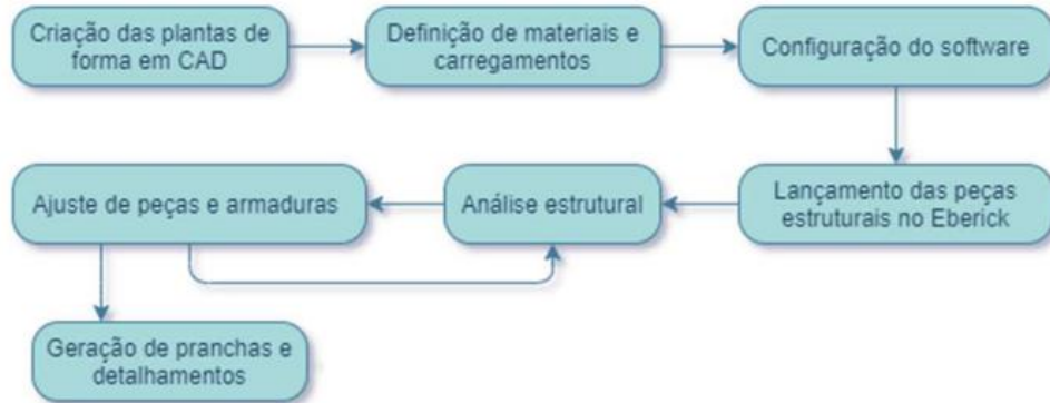
Figura 2 – Fluxograma de desenvolvimento projeto estrutural
