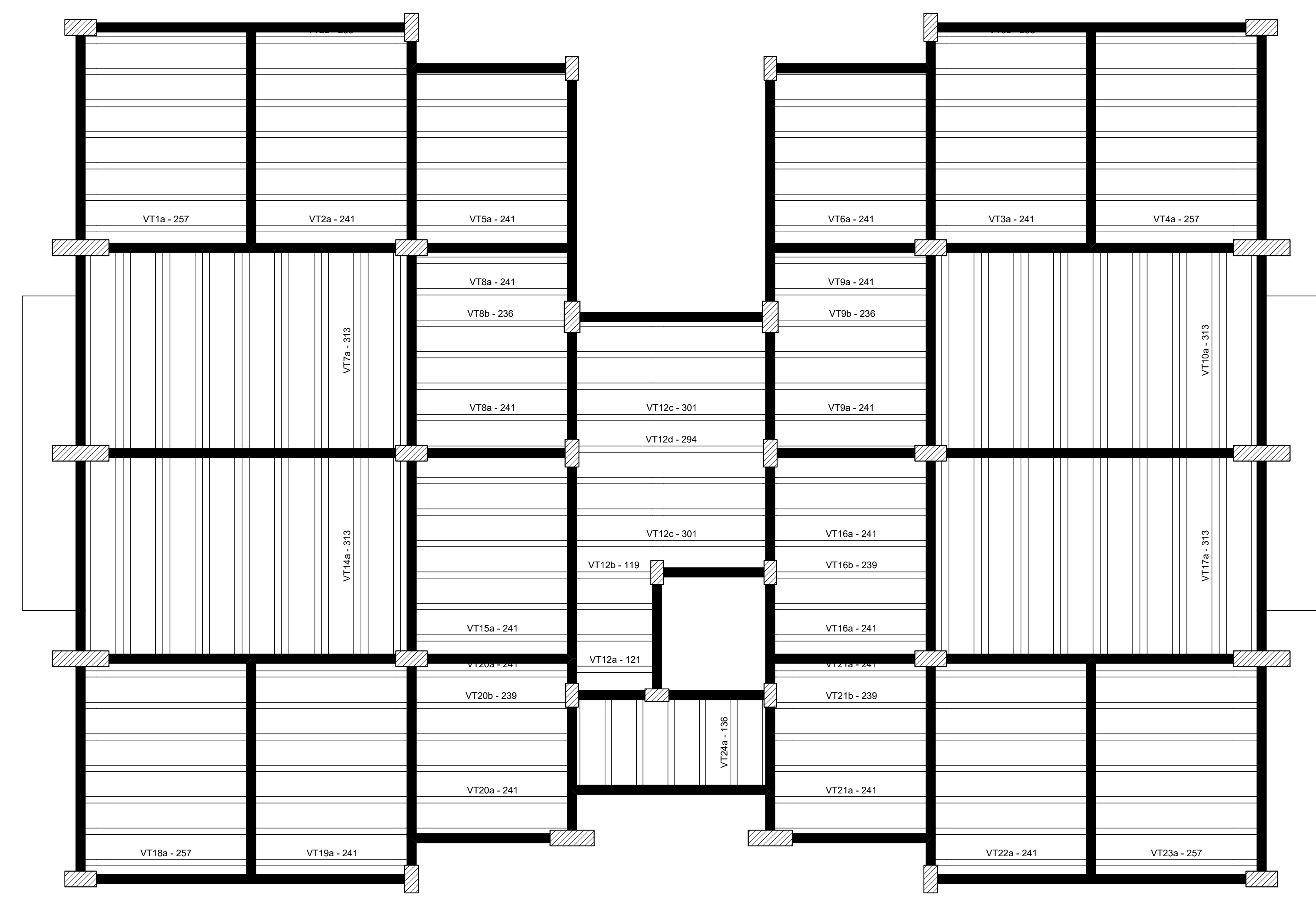
PLANTA DE VIGOTAS PRÉ-MOLDADAS TETO TIPO
