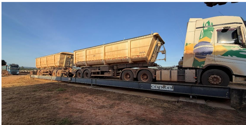
Figura 14: Pesagem de caminhão.
