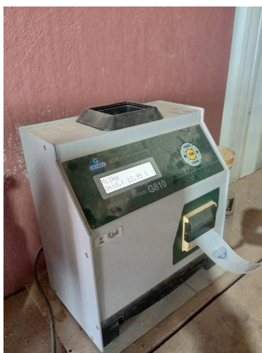
Figura 15: Determinação de umidade grãos.
