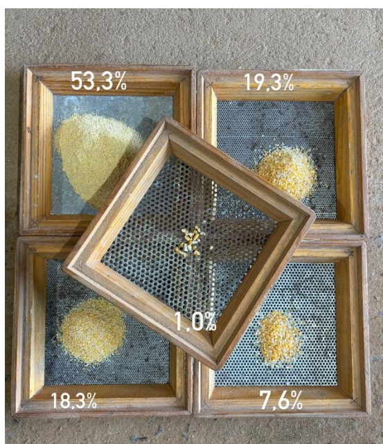
Figura 17: Teste de granulometria no milho muido.
