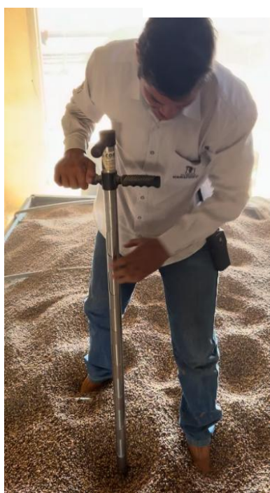
Figura 16: Amostragem com calador.
