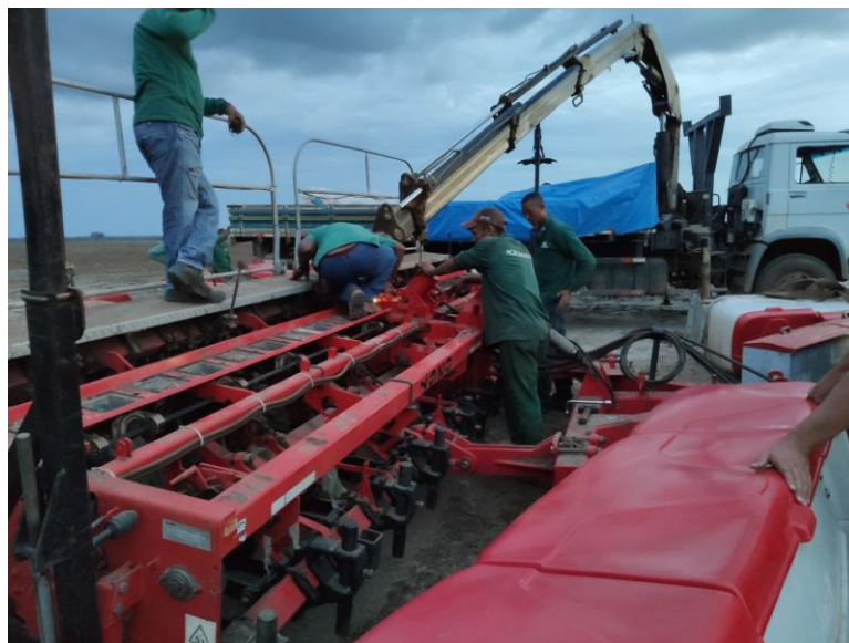
Figura 5: Realização de conserto em plantadeira com apoio de caminhão munck após quebra do conjunto hidráulico elevador.
