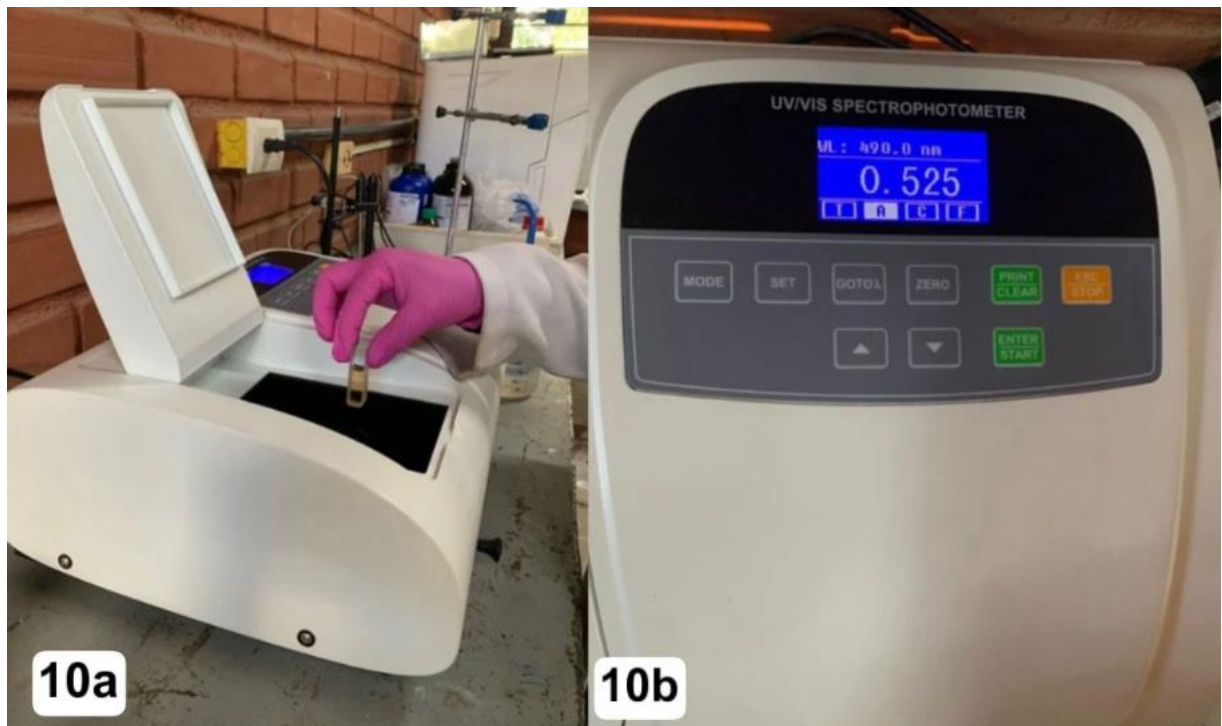
10a: Amostra tratada com fenol e ácido sulfúrico sendo colocada no espectrofotômetro ; 10b: Leitura do teor de polissacarídeos da amostra. Fonte: Arquivo pessoal, 2025.
