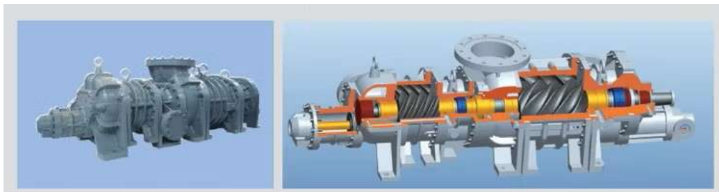
Figura 16 - Princípio de funcionamento de um compressor de parafuso de dois estágios.
