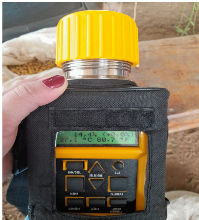
Figura 5 - Avaliação de Umidade
