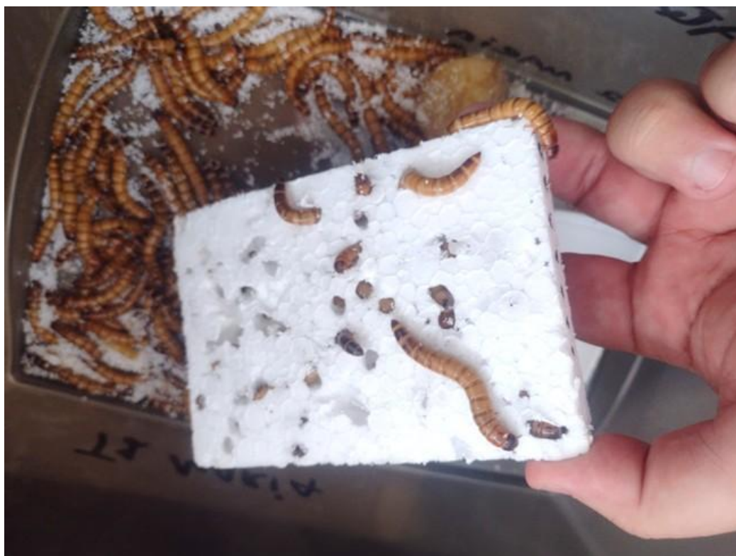
Figura 06: Aspectos da perfuração entre faces do EPS em placa (isopor), e a quantidade de pó branco (microplásticos) produzidos.
