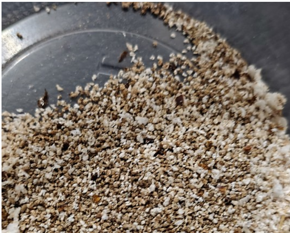
Figura 5: Aspectos da destruição do EPS pelos tenébrios gigantes, produzindo microplásticos (pontos brancos), que se misturam as fezes (pontos marrons).
