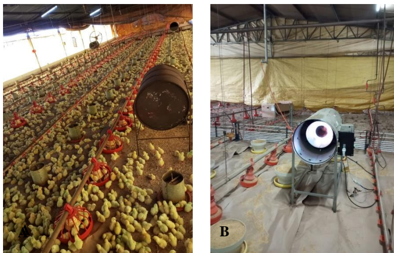
Figuras 56 e 57 – (A) Aquecedores para pintinhos a lenha (B) Aquecedor a gás (Arquivo pessoal, 2025) – Autorizado pela empresa.
