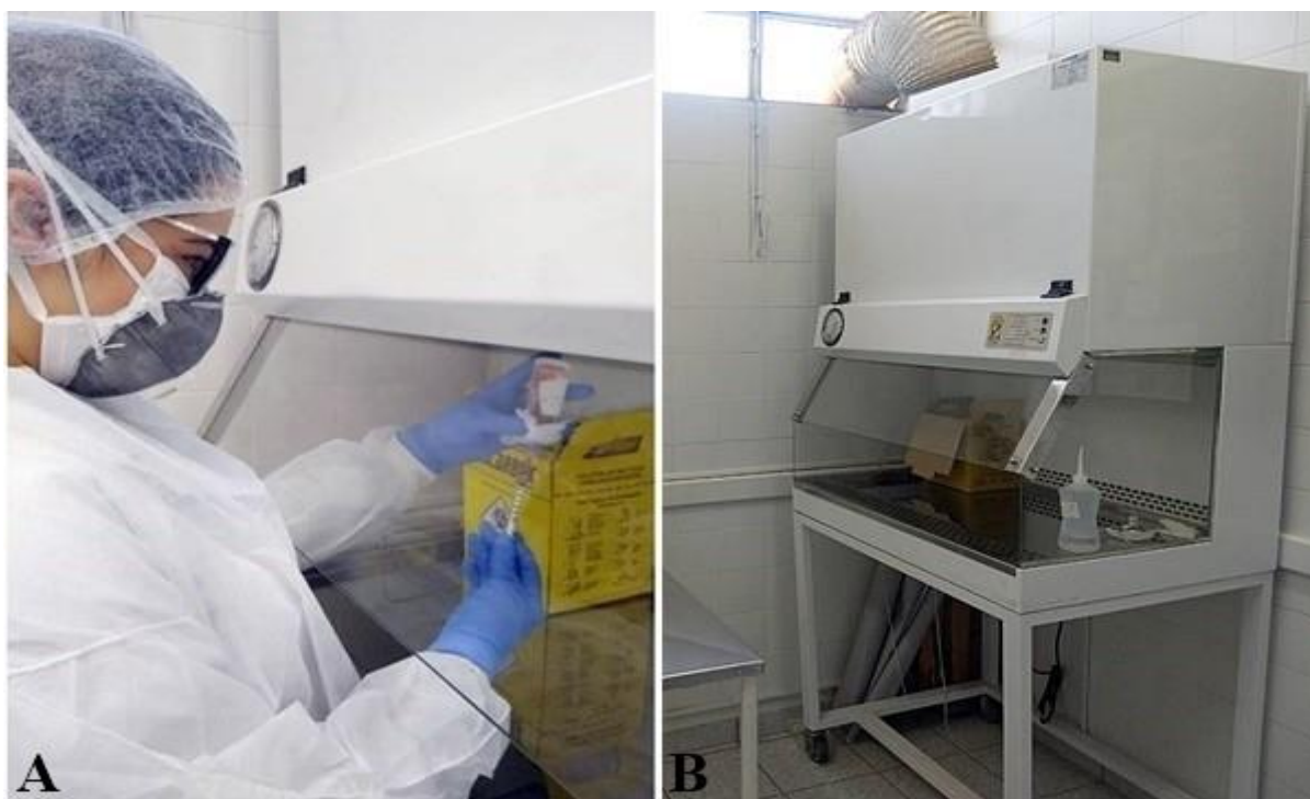
Figura 8. A- Manipulação de quimioterápico com equipamento de proteção individual. B- Câmara de fluxo do setor de oncologia veterinária. Fonte: Arquivo Pessoal (2019).
