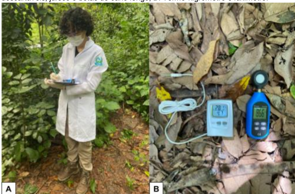
Figura 3- A: Uso de equipamentos de proteção individual (EPI 's): luvas e máscaras descartáveis, jaleco e botas de cano longo; B: Termo-higrômetro e luxímetro.
