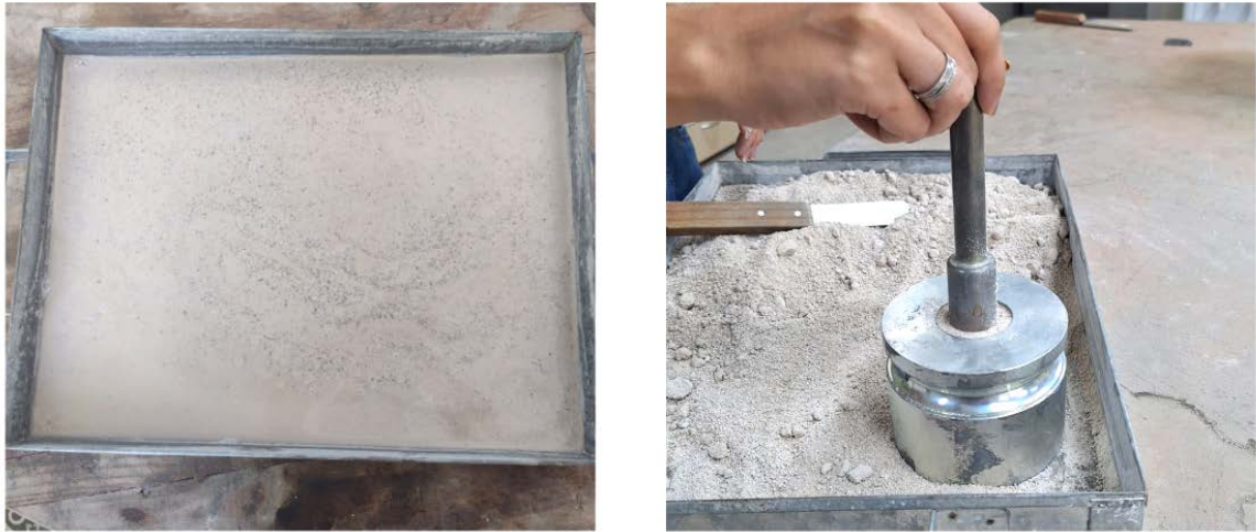
Figura 8: (a) Saturação da concha triturada e (b) compactação da amostra no molde tronco-cônico.
