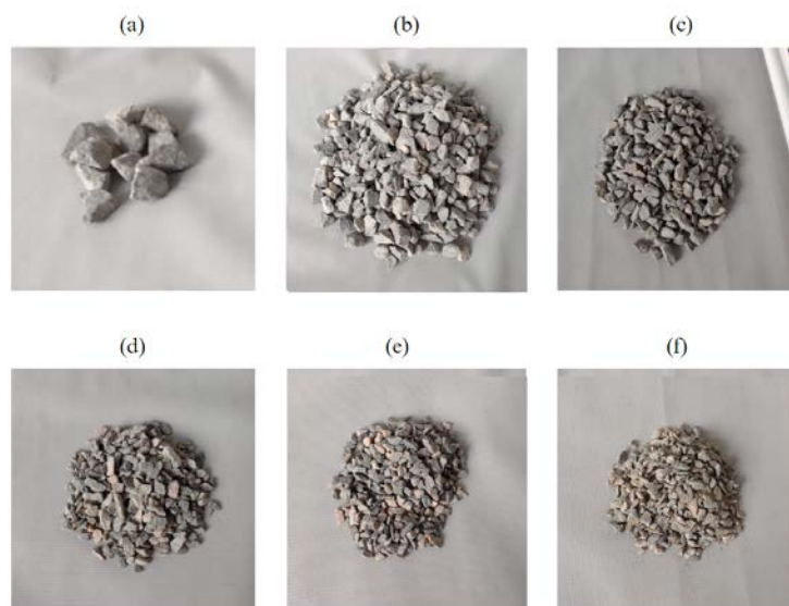
Figura 29: Amostra de massas retidas do agregado graúdo nas respectivas malhas e fundo.
