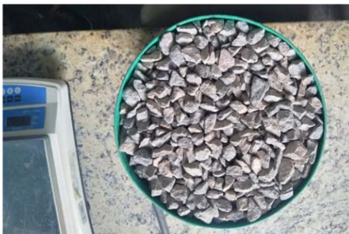
Figura 18: Recipiente com o agregado graúdo após a compactação e pesagem.
