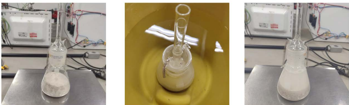
Figura 9: (a) Massa do conjunto frasco-concha, (b) frasco em banho e (c) massa do conjunto frasco-concha-água.
