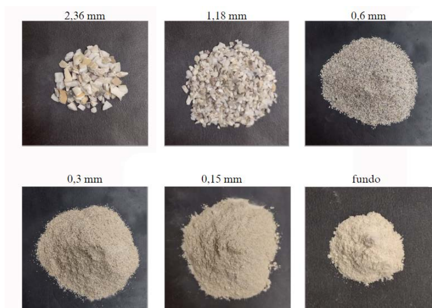
Figura 25: Amostra de massas retidas de concha de marisco nas respectivas malhas e fundo.
