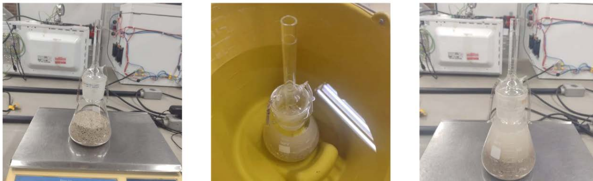
Figura 14: (a) Massa do conjunto frasco-areia, (b) frasco em banho e (c) massa do conjunto frasco-areia-água.
