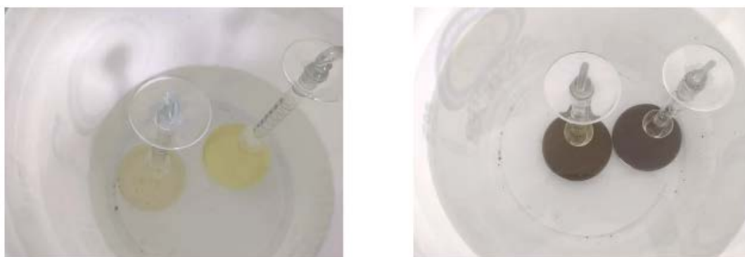
Figura 11: (a) Frasco em banho com a querosene e (b) Frasco em banho com o aglomerante.
