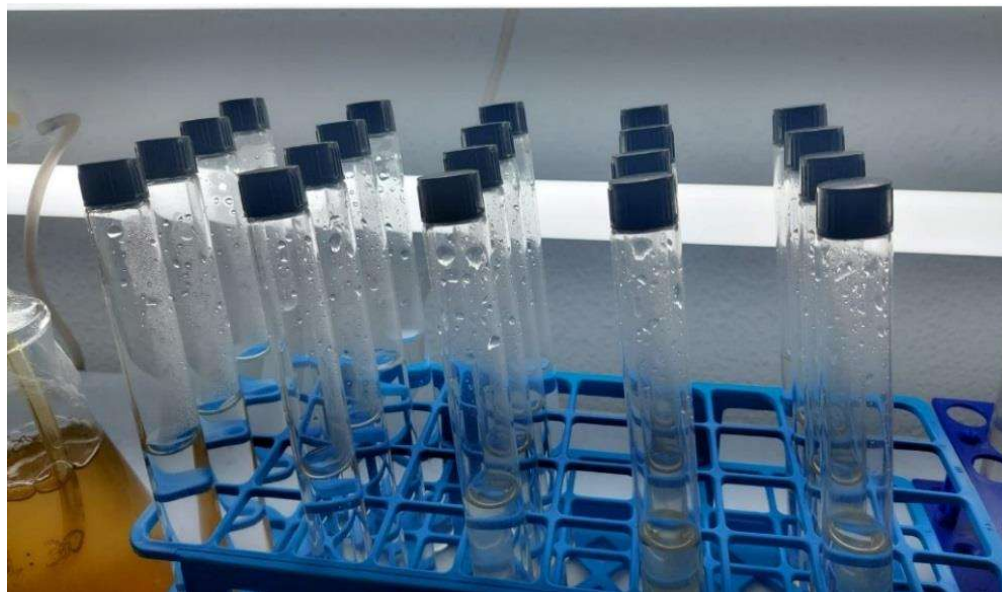
Figura 5. Tubos de ensaio de 50 mL de volume total com tampa rosqueável.
