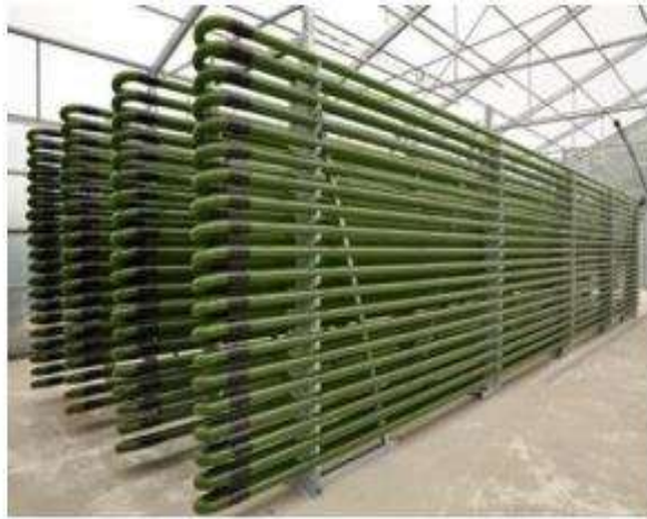
Figura 4 – Exemplo de um fotobiorreator tubular utilizado em cultivos em massa de microalgas
