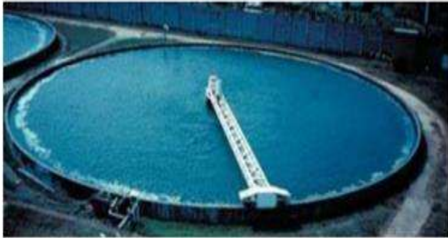
Figura 2- Lagoa circular para cultivo de microalgas
