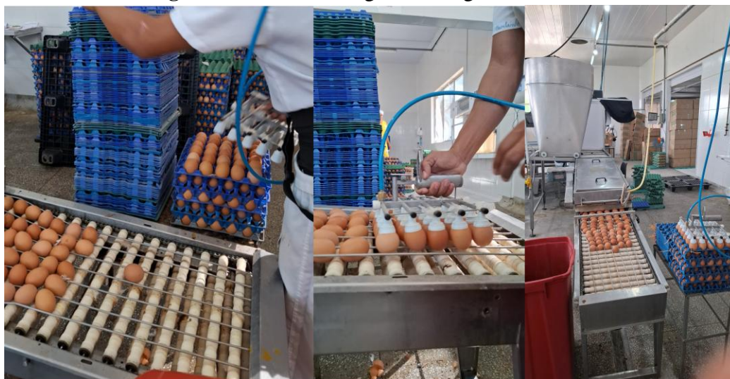
Figura 35. Esteira, lavagem e secagem dos ovos.
