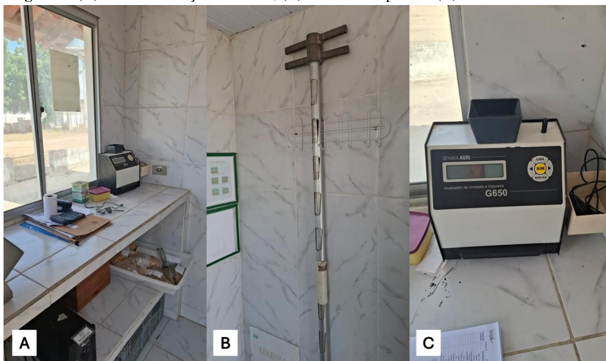
Figura 3. (A) Sala da balança rodoviária, (B) calador composto e (C) medidor de umidade.
