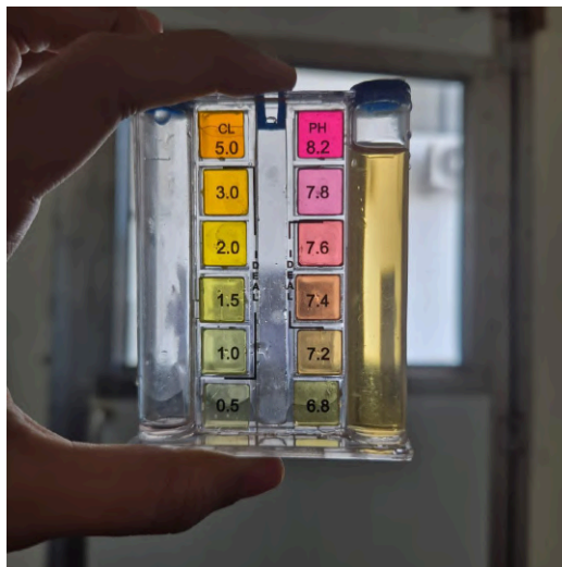
Figura 17. Análise de pH da água da barreira sanitária 1. Fonte: Arquivo pessoal.
