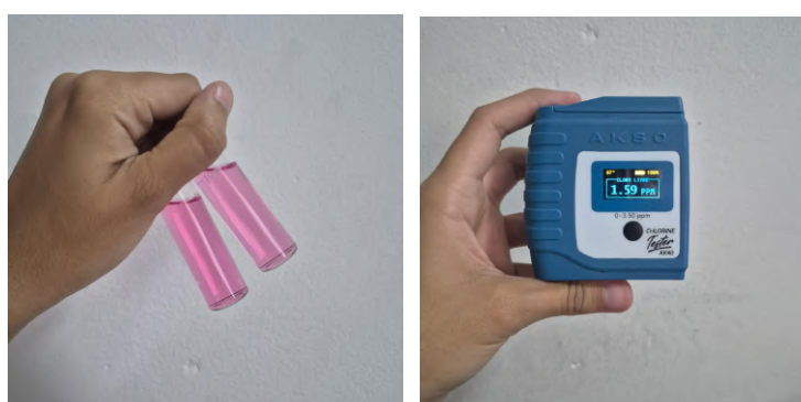
Figura 18. Análise de cloro residual livre na água. Fonte: Arquivo pessoal.
