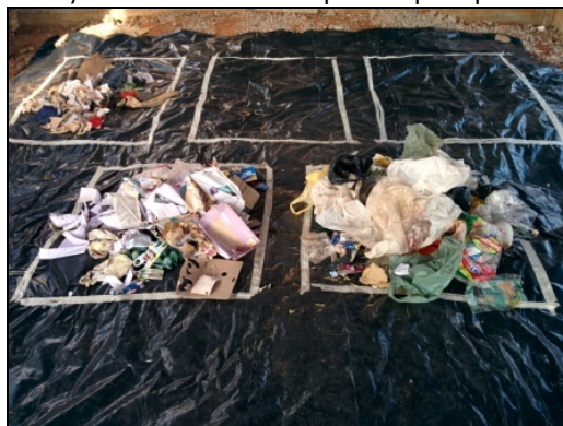
Figura 1. Segregação manual dos resíduos para os 05 (cinco) tipos de quadrados (papel e papelão, plásticos, metais, vidros e outros). Resíduo familiar separado para posterior pesagem
