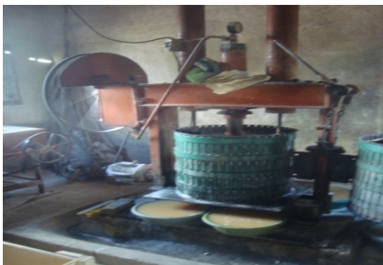
Figura 7 A - Prensagem da mandioca e produção de resíduo líquido (manipueira) em casa de farinha n°. 1 no Sítio Olho D' Água Velho em Lajedo
