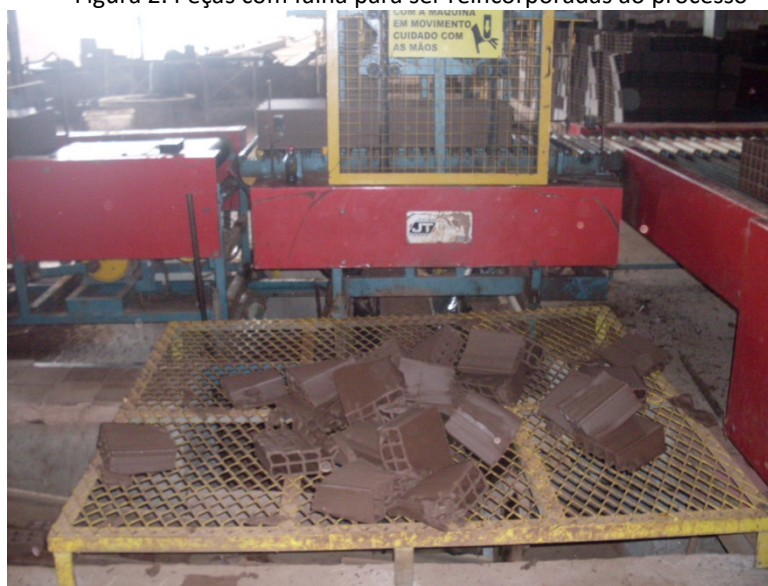
Figura 2. Peças com falha para ser reincorporadas ao processo
