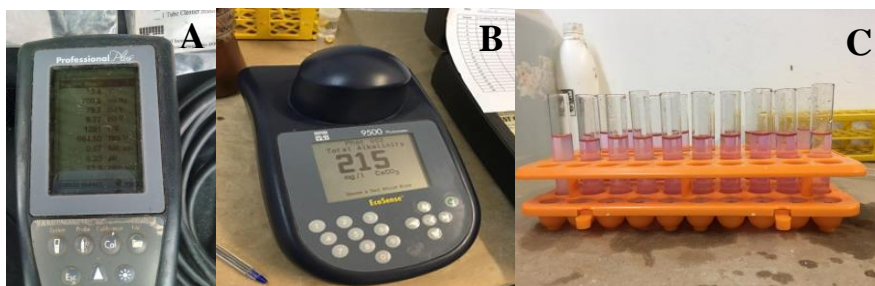
Figura 3: Equipamentos utilizados para monitoramento da qualidade de água, (A) sonda multiparâmetro, (B) espectrofotômetro, (C) análise dos nutrientes.
