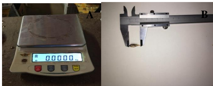
Figura 4: (A) Balança digital peso em (g), (B) Paquímetro digital, análise de comprimento em (mm) das pós-larva O. niloticus .
