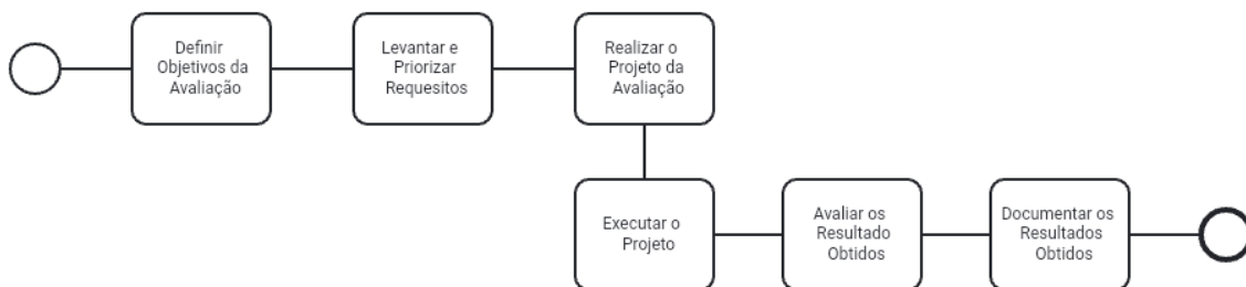
Figura 1. Fluxo do processo metodológico de testes de penetração em ambientes IoT.
