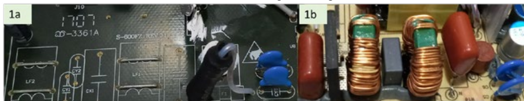
Figura 1 - Trecho do circuito de uma fonte chaveada responsável pelo filtro de ruídos elétricos
