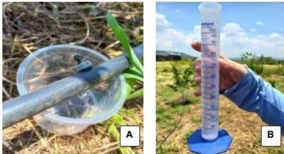
Figura 5 - Teste de eficiência (A); Coleta da vazão em função de 30 segundos (B)
