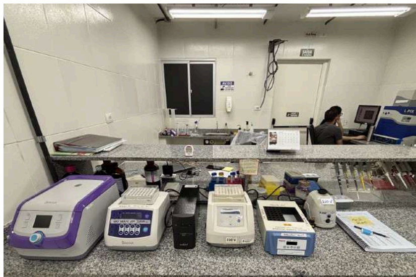
Figura 4 – Infraestrutura do LabMol, evidenciando uma centrífuga, três banhos-seco e pipetadores em primeiro plano. Ao fundo e à direita, um fotodocumentador.
