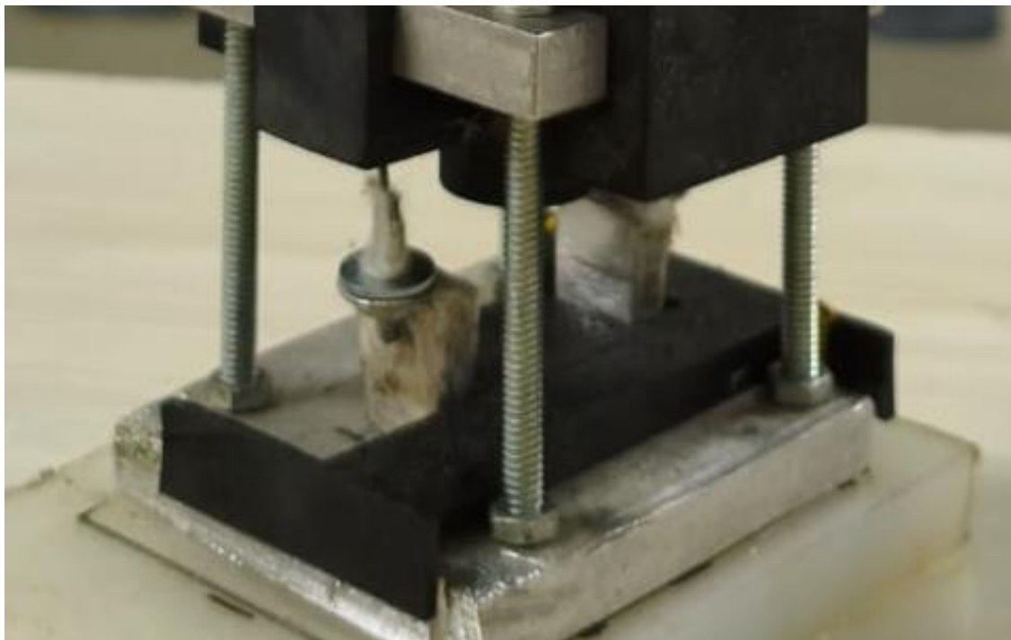
Figura 18 – Base de fixação da amostra.
