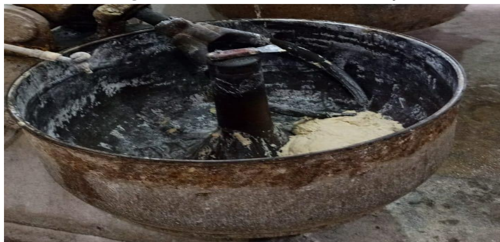
Figura 37: Batedeiras em estado de deterioração.
