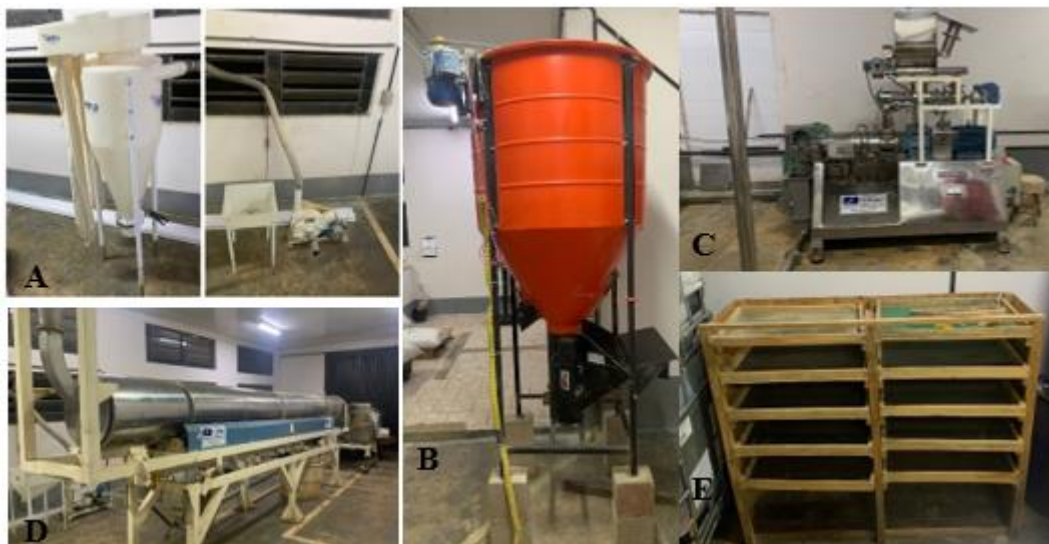
Figura 2: A moedor modelo 280 Vieira moinhos e martelos, B misturador MRO 300 plus MFW, C extrusora modelo E-62 Ferraz, D secador tubular, E Resfriador Artesanal.
