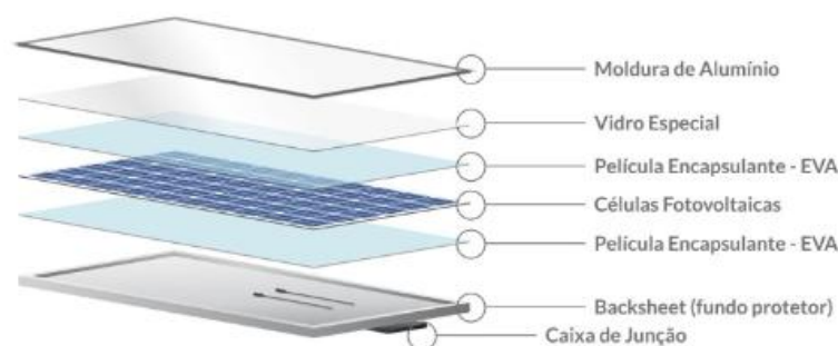
Figura 5 – Composição de um módulo fotovoltaico.
