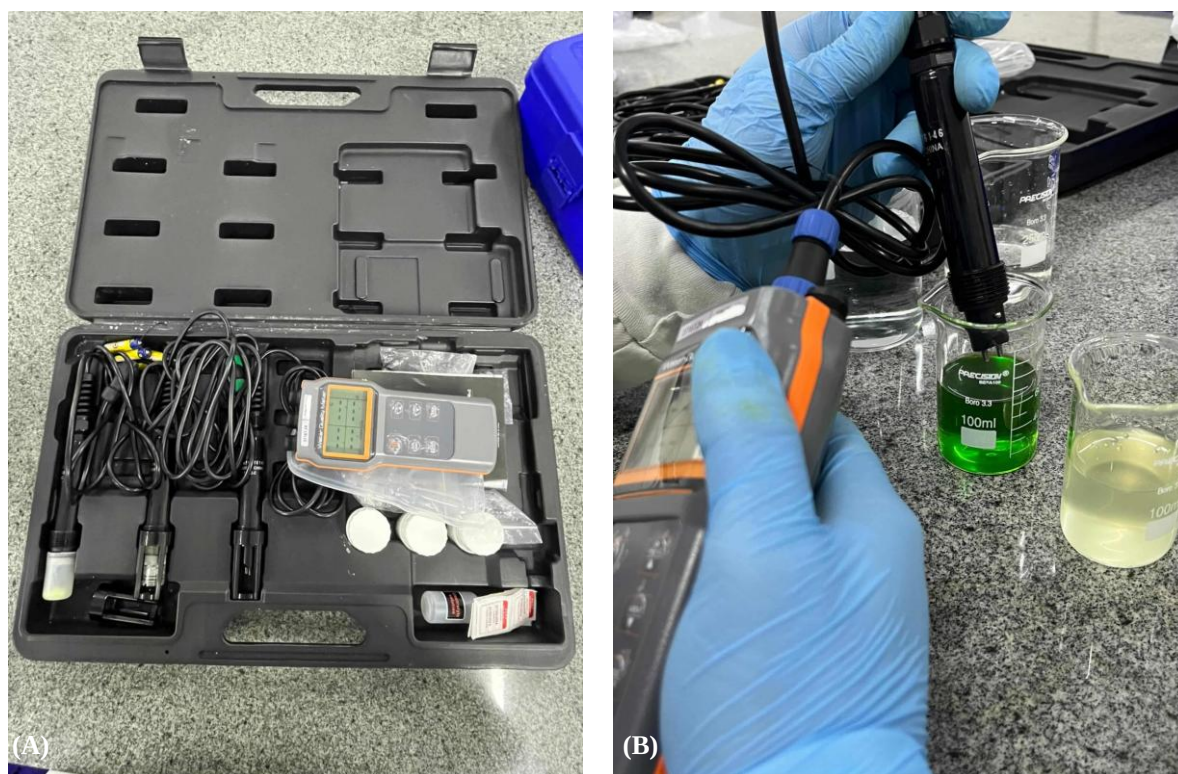
Figura 9. Monitoramento das variáveis físico-químicas dos compostos de aveloz. (A) Sonda multiparâmetro; e (B) análise realizada com a sonda multiparâmetro
