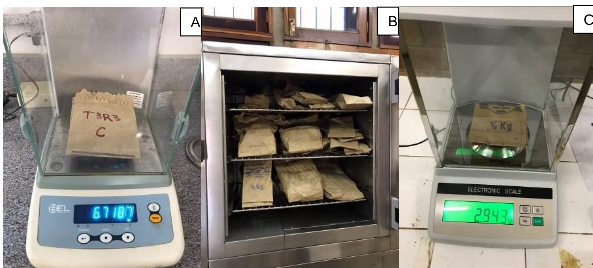
Figura 4. Mensuração da massa fresca (A), secagem em estufa (B) e mensuração da massa seca (C) do material vegetal das mudas do maracujazeiro BRS Rubi do Cerrado.
