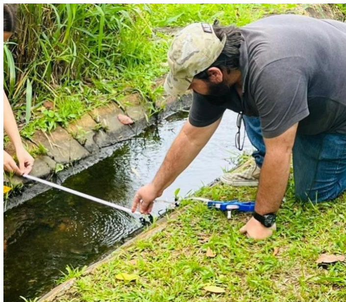
Figura 7. Medição da distância do canal de abastecimento de água na Base de Pesca da UFRPE para avaliação da vazão hídrica. (Fonte: Acervo pessoal.)
