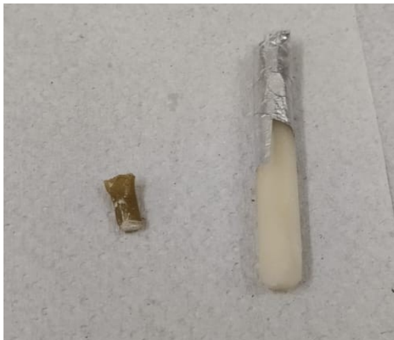
Figura 12 – Comparação do reagente encapsulado de ferrocianeto com (a direita) e sem (a esquerda) refrigeração, depois de 3 meses.
