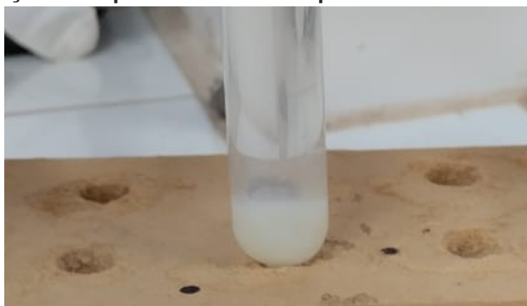
Figura 7 – Reação da cápsula de iodeto de potássio com acetato de chumbo.
