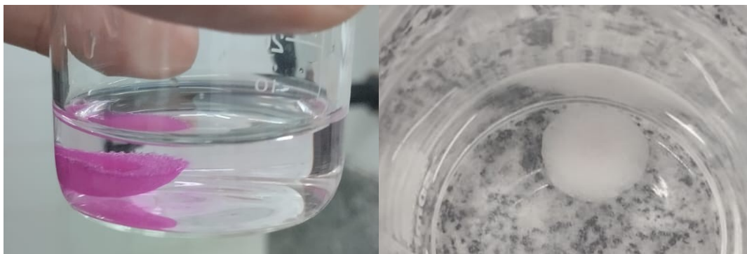
Figura 6 – Reações das cápsulas de fenolftaleína em solução básica (A) e ácida (B).
