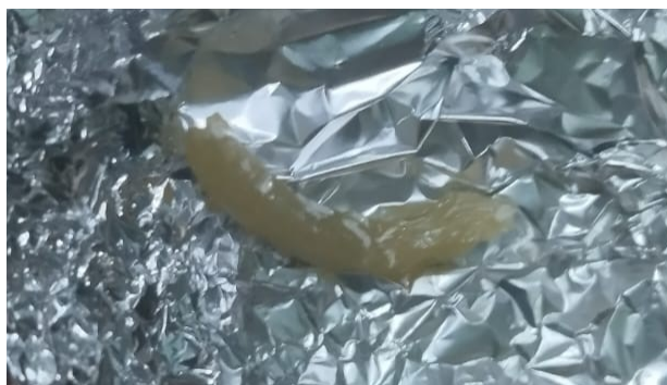
Figura 11 – Ferrocianeto de potássio encapsulado 3 meses após a sua produção.
