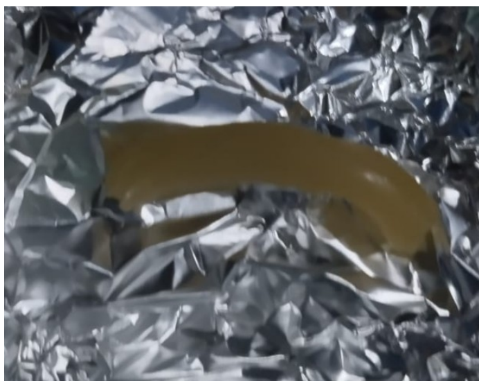
Figura 10 – Ferrocianeto de potássio encapsulado 5 dias após a sua produção.
