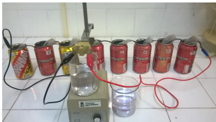
Figura 2. Pilhas ligadas em série com a energia gerada sendo usada para tratar a solução de corante.
