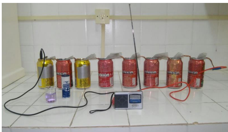
Figura 3. Pilhas ligadas em série com a energia gerada sendo usada para ligar um rádio.
