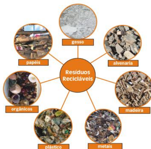
Figura 1. Coleta / separação de RCC
