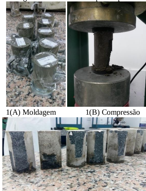
1(C) Corpos de prova rompidos
