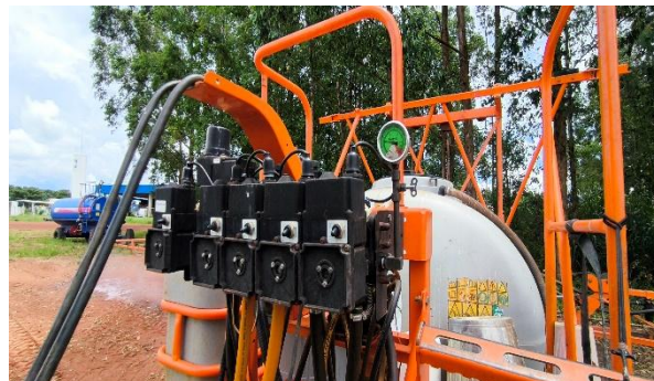
Figura 40. Comando de válvulas e manômetro de pressão do aplicador
