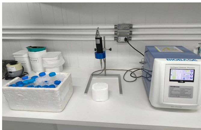
Figura 26. Sonicando as proteínas após ressuspensão em tampão PBS1x
