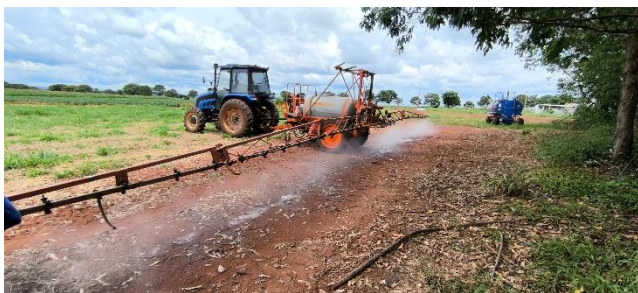
Figura 30. Teste de vazão e limpeza dos bicos de pulverização
