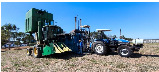
Figura 59. John Deere 9930 descarregando na prensa hidráulica
