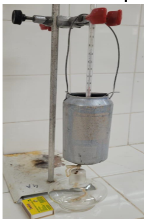
Figura 19– sistema aberto usado na queima de combustível
