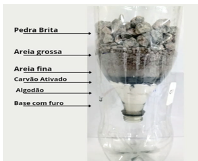
Figura 5- funil de separação construído para simular em pequena escala uma ETA.
