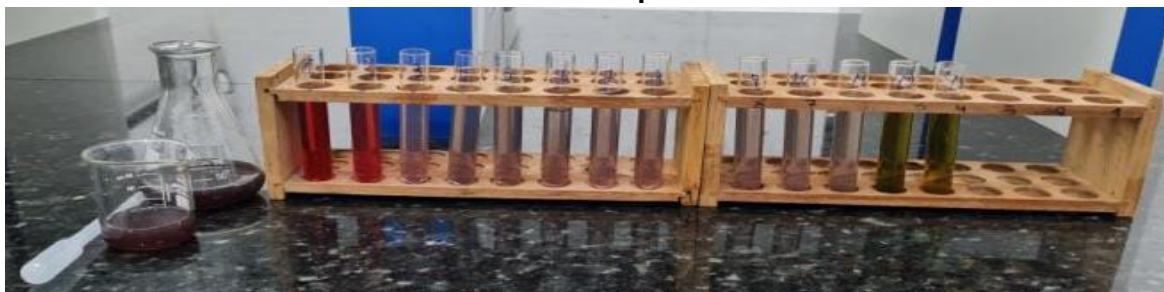
Figura 18- extrato de feijão preto como indicador ácido-base e sua reação exposto a diferentes pHs
