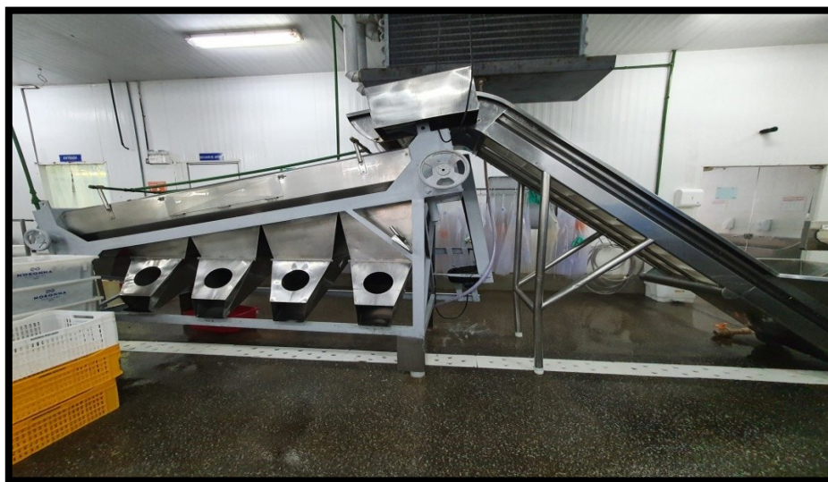
Figura 18 - Máquina classificadora de camarão
