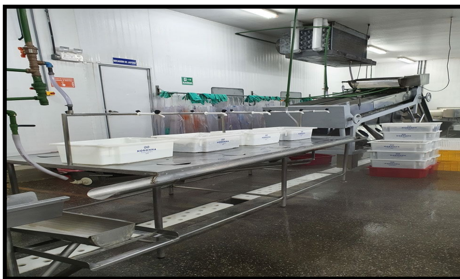
Figura 19 - Mesa classificadora dos camarões
