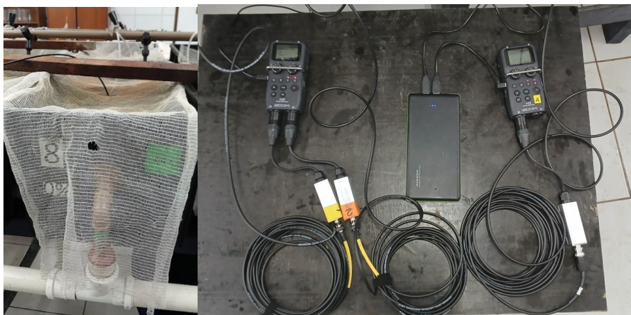
Figura 1. Sistema de gravação utilizando o gravador modelo H5 (Zoom North América) conectado ao hidrofone de modelo AS-1 acoplados a pré-amplificadores PA-4 (Aquarian Áudio) utilizados no experimento. O power bank utilizado como fonte de energia para o funcionamento do gravador.
