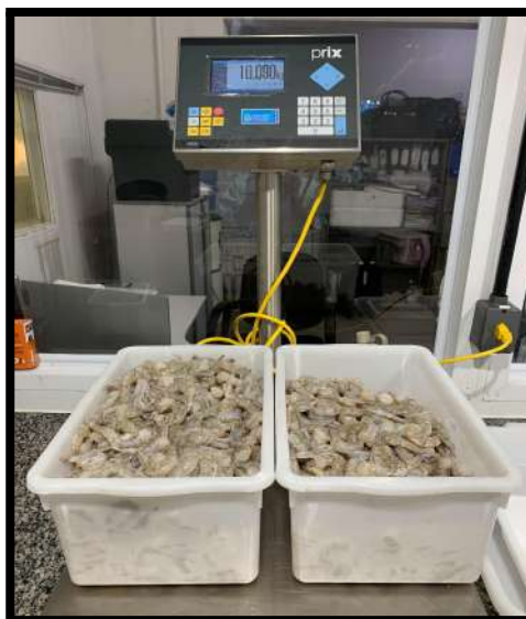
Figura 55. Pesagem da amostra após o primeiro tempo de drenagem
