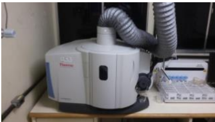
Figura 4 - Equipamento de ICP OES usado na quantificação multielementar.
