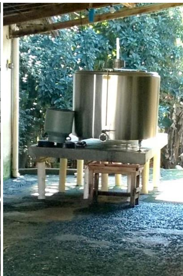
Figura 33: Tanque resfriador - Capril Inli
