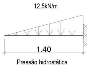
Figura 32 – Esforço da pressa hidrostática na parede.
