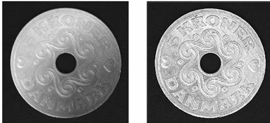
Figura 7 – Uso da iluminação do tipo Ring Light .
