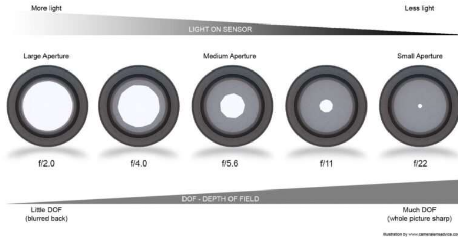
Figura 26 – Representação da relação de abertura de lente, captação de luz e profundidade de campo.
