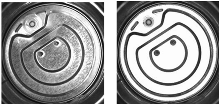
Figura 10 - Uso de iluminação On-axis para melhorar o contraste entre áreas.
