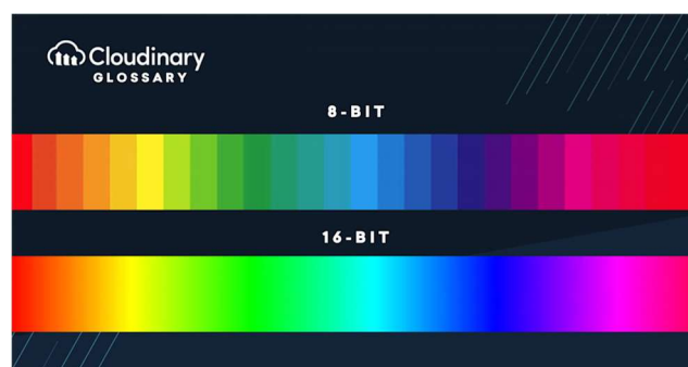
Figura 6 – Exemplo da relação entre profundidade de bits e variações de cor em uma imagem.
