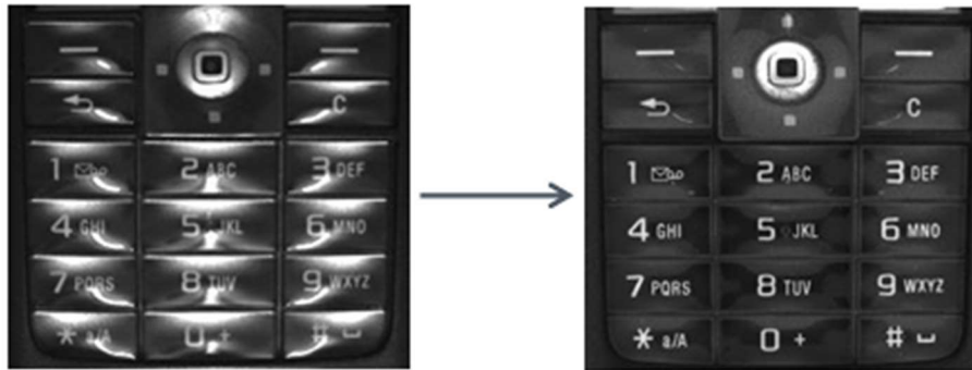
Figura 11 - Uso de iluminação Flex Dome para filtrar o excesso de luz.
