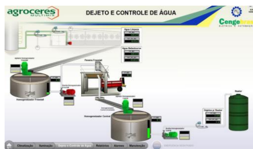
Figura 13. Controle do sistema de dejetos.
