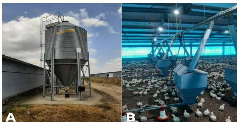
Figura 35 - (A) Silo de armazenamento de ração. (B) Caixas de distribuição de ração. Fonte: Arquivo pessoal, 2025. (Autorizado pela empresa)
