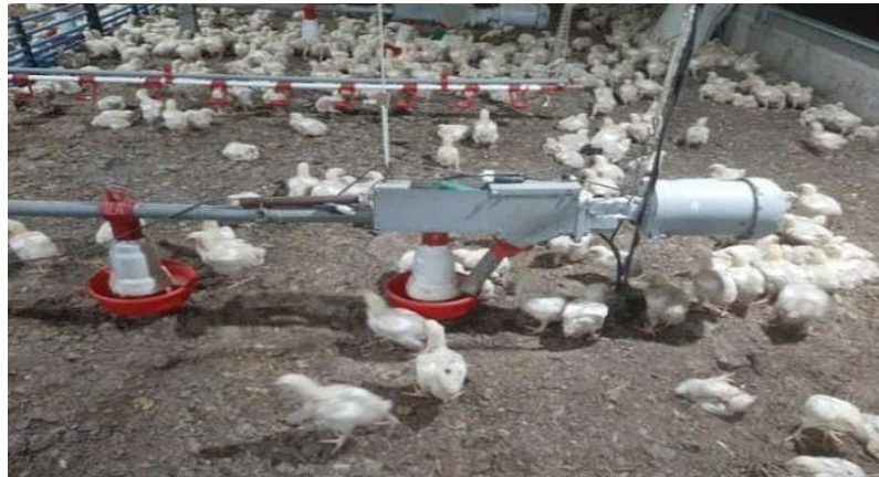
Figura 36 - Prato de comando na extremidade da linha de ração. Fonte: Arquivo pessoal, 2025. (Autorizado pela empresa)
