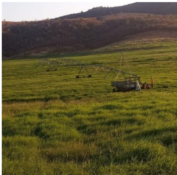
Figura 28 – Lance do pivô baixado para conserto, retirado o canhão
